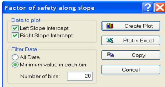
Esto creará un gráfico del factor de seguridad a lo largo de la superficie del talud. Los valores del factor de seguridad se obtienen de cada superficie de falla/ punto de intersección del talud.
